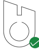
Si la apertura es intencionada, y aún en piezas grandes, el archivo se puede fabricar con normalidad. Por ejemplo en piezas metálica o de metacrílico, esta apertura de 20mm en el círculo se puede dejar así para más tarde doblar este espacio y hacer una pieza de apoyo.
