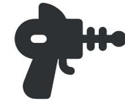
Este caso es incorrecto, ya que aunque se ha asignado un grosor de trazo al dibujo, la vista al pasar a modo relleno nos muestra el resultado real de cómo se grabará. El software de las máquinas láser no detecta los grosores de las líneas, solo detecta los vectores por donde debe transcurrir o áreas cerradas, que se grabarían como grabado superficie si están en la capa correspondiente, o cómo uno de los 3 tipos de grabado línea, cuando están en esa capa y color
